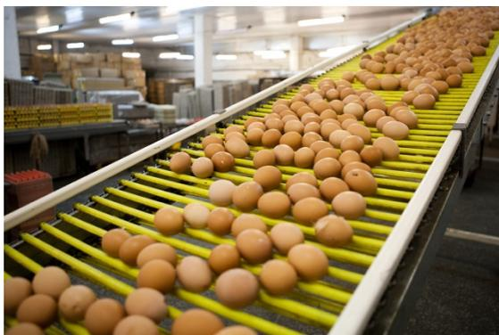
Les exigences de maintenance sont étroitement liées à l'emplacement de l'équipement de codage et aux procédures de nettoyage. Le codage des œufs en ligne directement en aval de la zone de transfert est potentiellement la zone la plus salissante, étant donné que les calibreuses éjectent souvent les œufs dans cette
